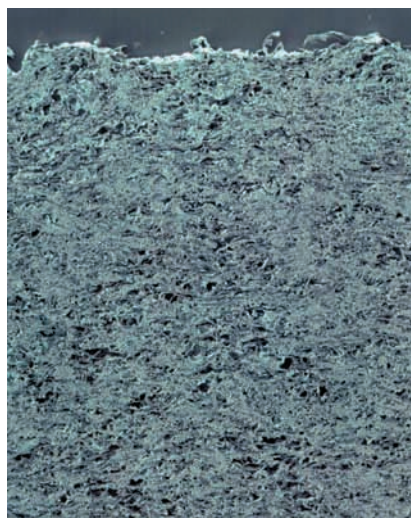
Coupe transversale de plaques filtrantes en profondeur au microscope
